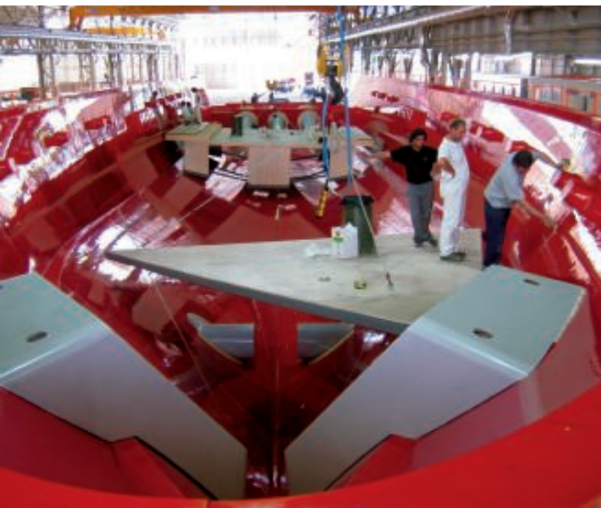
Vista interna della prima parte di prua (25 m) dello stampo pianale di coperta (per gentile concessione Cantiere Effebi – Overmarine)
