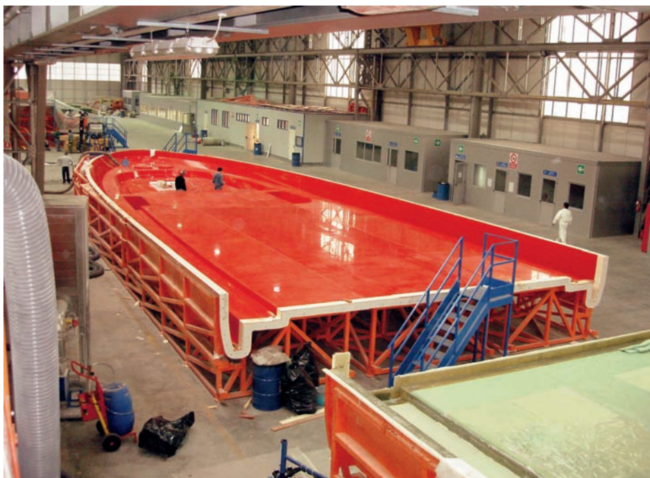
Vista interna dello stampo diretto dello scafo del 165' (Per gentile concessione del cantiere Effebi-Overmarine)
