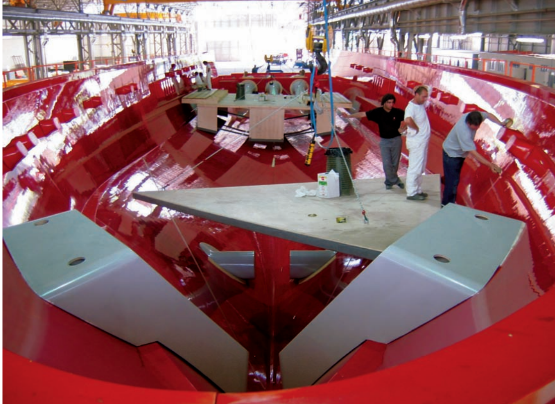
Vista interna della prima parte di prua (25 m) dello stampo pianale di coperta (per gentile concessione Cantiere Effebe – Overmarine)
