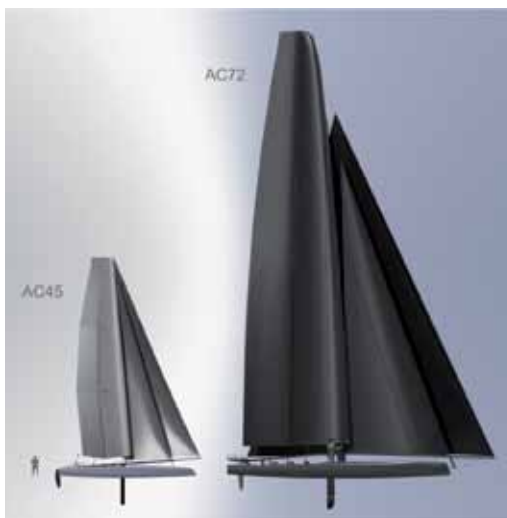
L’AC45 è il catamarano che sarà utilizzato per il primo anno per le “World Series” (ACWS), uguale per tutti i team; si passerà poi a un 72 piedi, progettato e costruito dagli stessi team
